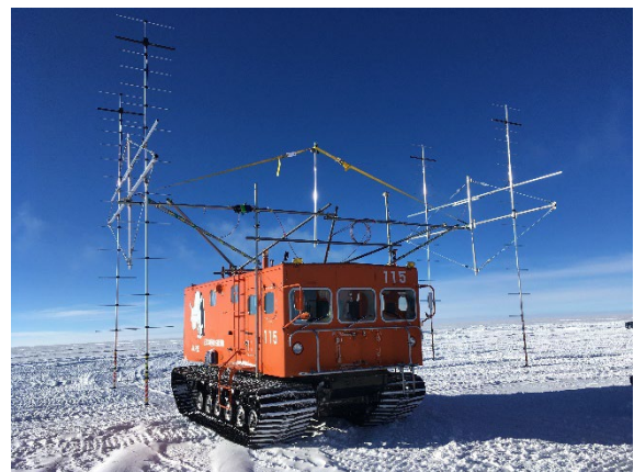
図 1: レーダアンテナを搭載した雪上車。 国立極地研究所 藤田秀二教授撮影。
